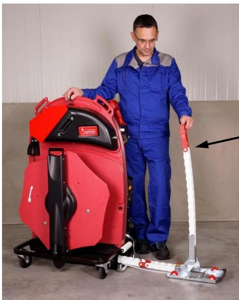
Maintenez l'extrémité de la chaîne de guidage avec la main gauche tout en continuant d'actionner le joystick en avant.
